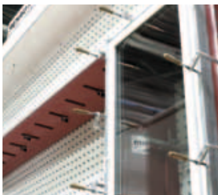
Ispitni uređaj za ispitivanje propusnosti na udare vetra
