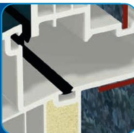
Vrlo dobra toplinska i zvučna izolacija zahvaljujući 6-komornoj geometriji i velikoj ugradbenoj dubini kod okvira i krila.
